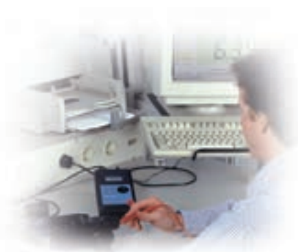
CEE Test 16A: Zum Messen des Differenzstromes von 3-phasigen Prüflingen unter Last.
