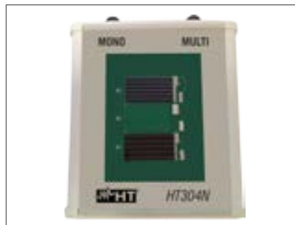
HT304N Duo-Referenzzelle für Einstrahlungsmessung
